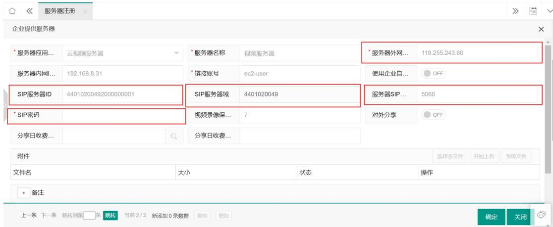
2) 第 7 项-输入服务器地址 IP: 每个摄像头对应应在【服务器注册】中设置的“服务器外网地址”，每个服务器根据购买的可连接摄像头数量配置，最多可连接 50 个摄像头
